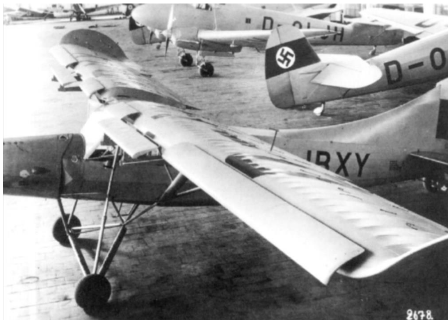
Das Fahrwerk und die Rumpfrückenflosse der Fi 156 V-1 sind hier gut zu sehen. Die FW 58 C im Hintergrund wurde damals bei Fieseler in Lizenz gebaut ebenso wie die ganz hinten stehenden Bf 109.
