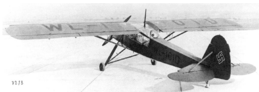
Drei Bilder von der Fi 156 B-0, W.Nr. 617, D- bzw. WL-IOID. Sie war zunächst das Musterflugzeug für die Serienausführung C-1 (Bild oben) und wurde dann nach dem Mustereinbau der Abwehrbewaffnung (SO 2) auch zum Musterflugzeug für die nachfolgende Serie C-2.
