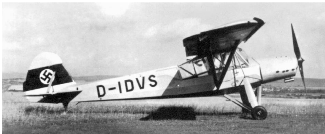
Als Beispiel für ein Flugzeug der Nullserie (A-0), die W.Nr.611 mit dem noch vornsitzenden Ölkühler. Der Vorflügel unter dem Höhenleitwerk ist aber bereits vorhanden.
