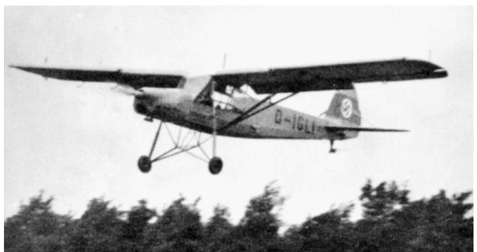
Die V-2 beim Landeanflug. Zu beachten sind bei diesem Flugzeug auch die nur über 2/3 der Spannweite reichenden feststehenden Vorflügel.
