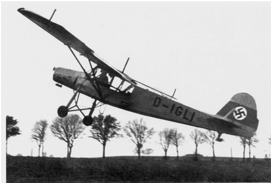
Die Fi 156 V-2 bei der Erprobung in Rechlin. Das leichtere Fahrwerk mit der Spurweite von nur 2,4 m, die stärkere V-Stellung der Flügel, das in Form und Größe noch nicht dem späteren Serienstand entsprechende Seitenruder sowie der vorne sitzende Ölkühler zeigen den Zustand des Flugzeugs im Herbst 1936.
