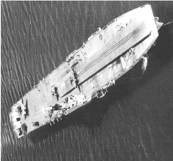
1950: Dampfkatapult auf dem Deck der HMS Perseus mit 2 de Havilland Hornet und einer Short Sturgeon.
